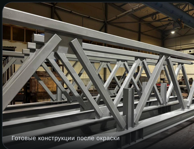
Стропильные фермы в цеху
